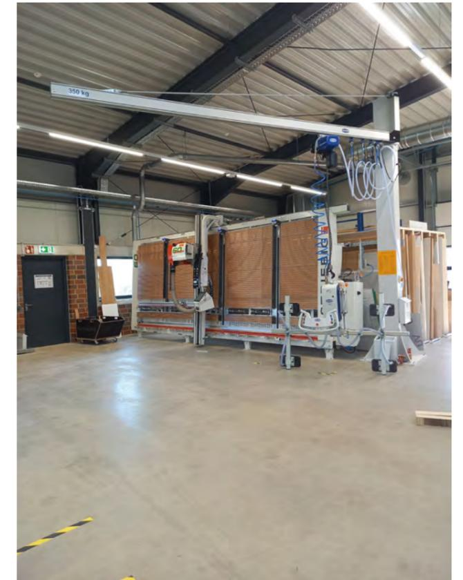
Eine moderne vertikale Plattenaufteilsäge mit Saugheber und Säulenschwenkkran.
